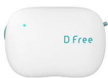
図1 使用した超音波排尿支援機器 (DFree)
