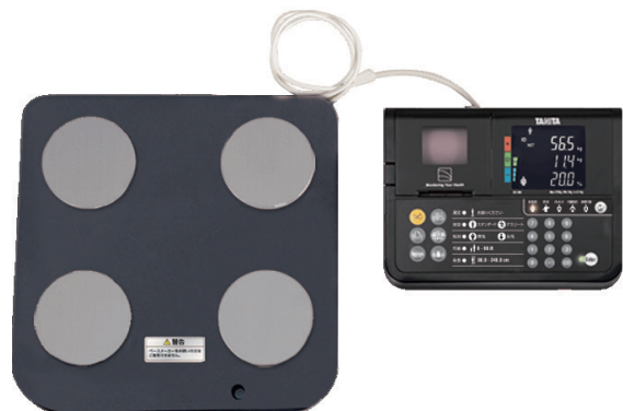
図2 TANITA社製デュアル周波数体組成計DC-430A セパレートタイプ
